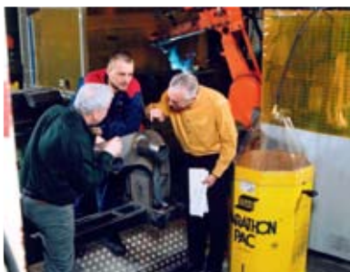
ESAB Marathon Pacs met 250 kg of 475 kg MIG/MAG lasdraad geven tot 95% reductie van stilstand voor het wisselen van draadspoelen.
